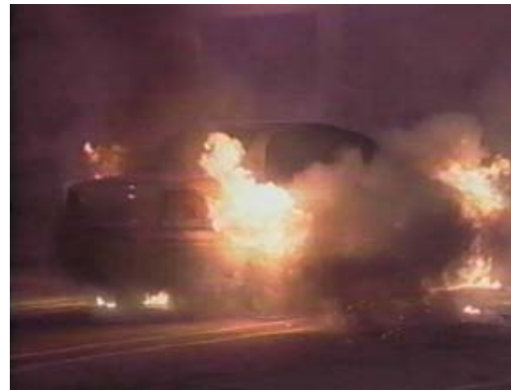
写真8 - Time: 2 min, 40 sec –運転席後部タイヤがはじけて 破片がとんでいる。
