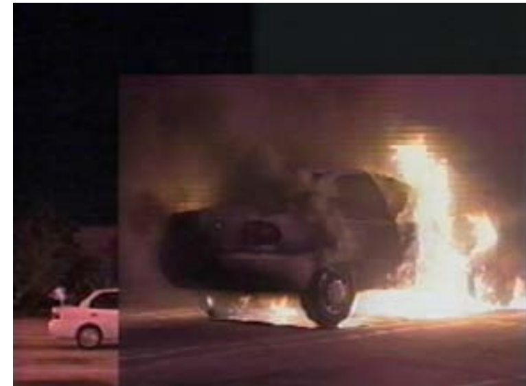
写真4 - Time: 1 min, 30 sec - 水素の放出は、ほぼ完了. ガソリン車のほうは、最も激しく燃焼している。
